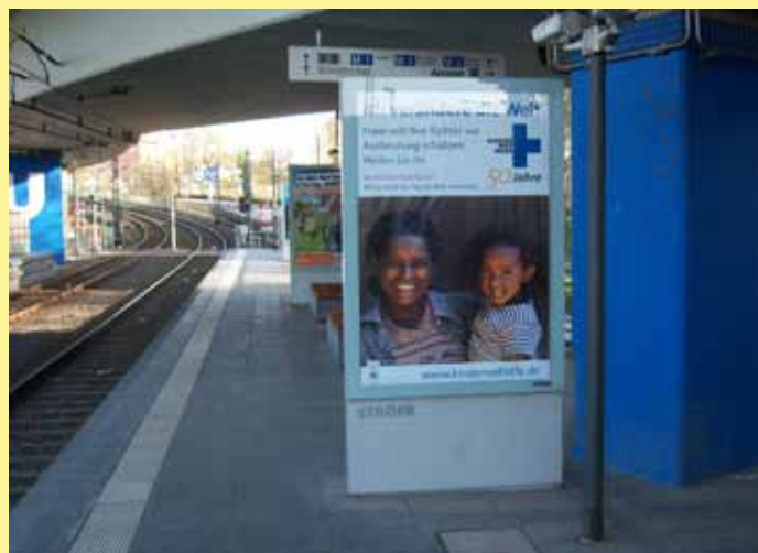
Werbeträger engen die Bahnsteigbreite in Hedderheim ein. Hier verdecken sie zudem den dahinterliegenden Ausgang und Wegweiserschilder.
