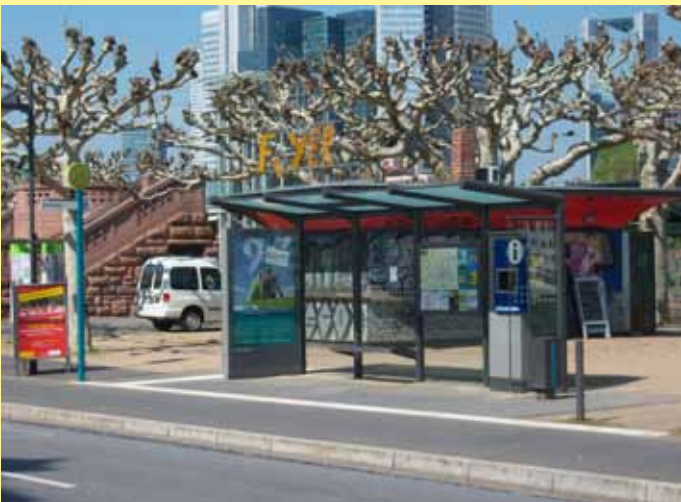
Positiver Ansatz beim Typ Xenon: In der langen Ausführung sind Bank und Infovitrine getrennt. Zudem ist teilweise eine Deckenbeleuchtung vorhanden.
