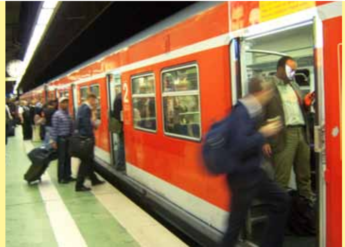
In Frankfurt ankommende Fluggäste müssen mit ihrem Gepäck in die S-Bahn „einsteigen“, weil der Bahnsteig nicht zur S-Bahn passt.
