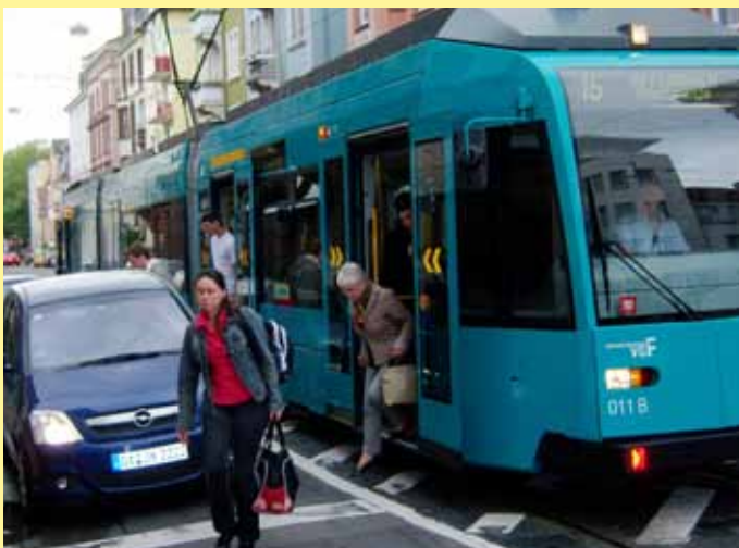
Nicht mehr zeitgemäß: Kein Bahnsteig und Behinderung des Ein- und Ausstiegs durch Autoverkehr (Beispiel: Schweizer-/Gartenstraße).
