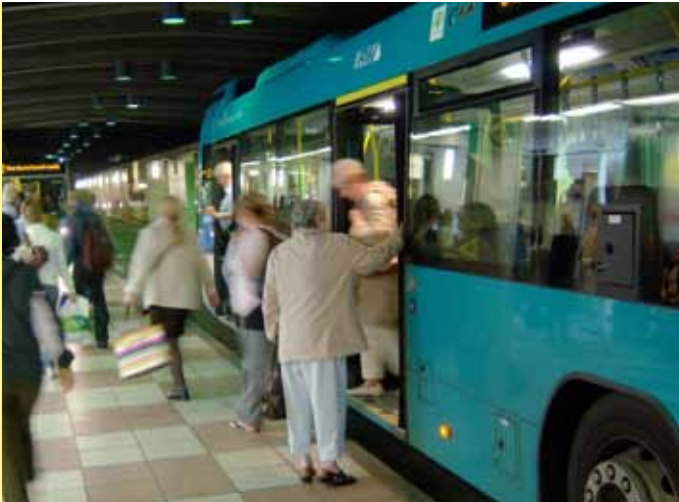
An der auch von älteren Menschen stark frequentierten Bushaltestelle Nordwestzentrum sind die Bussteige für einen bequemen Einstieg viel zu niedrig.
