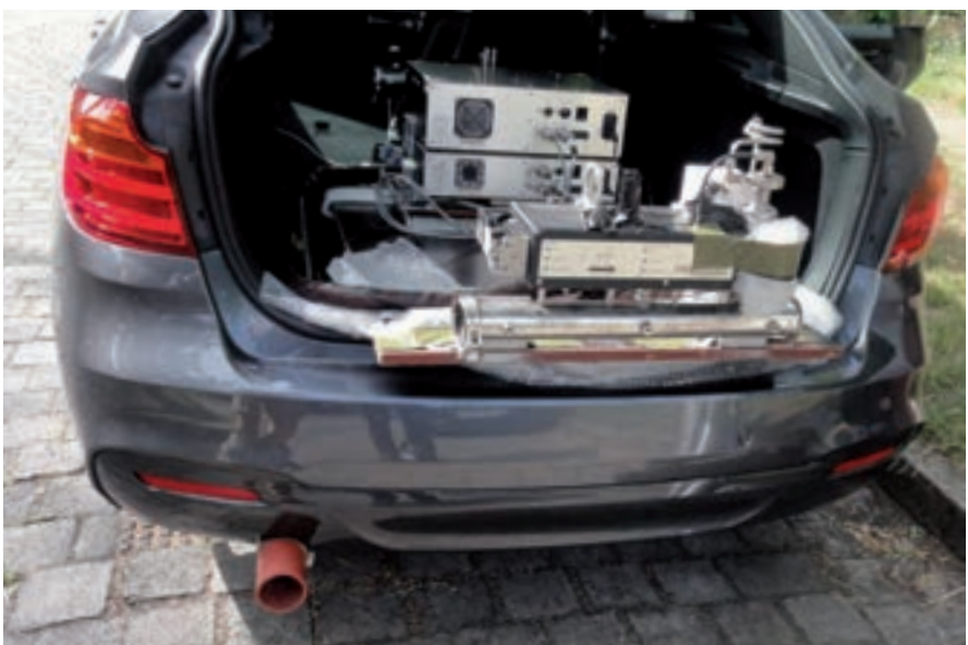
Das Auto wird für den Abgastest auf der Straße vorbereitet.
